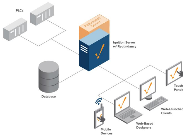
Figura 3 – Arhitectura simpla SCADA cu redundanta.
